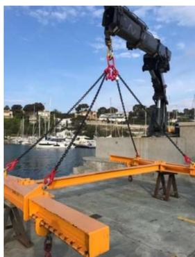
L'aire technique dispose pour l'exploitation d'une grue à potence de capacité maximale 10 tonnes (10,8 T à 7m, 12,4T à 6m, 18T à 4,10m)
